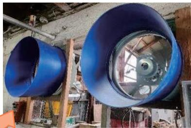
ギ酸タンクを輪切りにし、送風機に取り付ける
