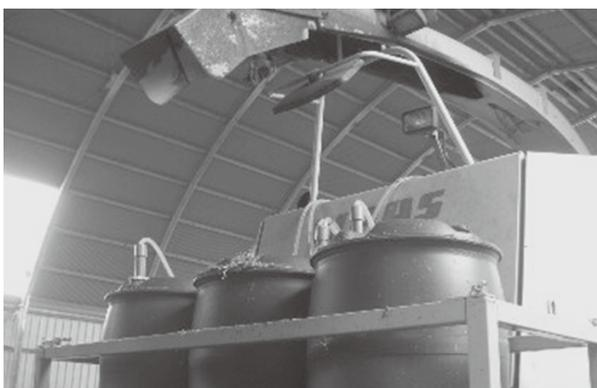
写真2 ギ酸タンクの設置
