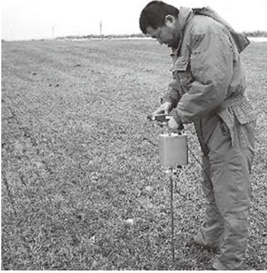
写真1 土壌の硬度測定
