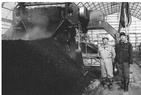
(写真2) 自走式堆肥攪拌機
