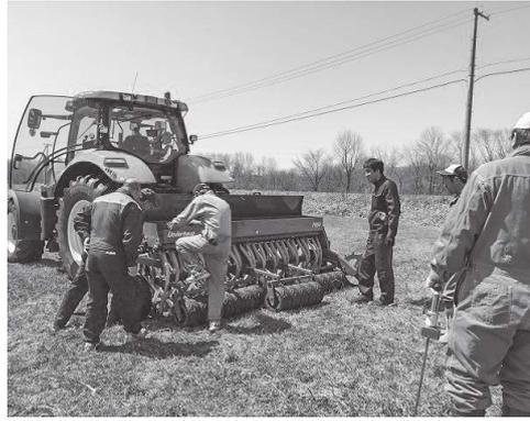
写真1 作溝播種機の調整作業
